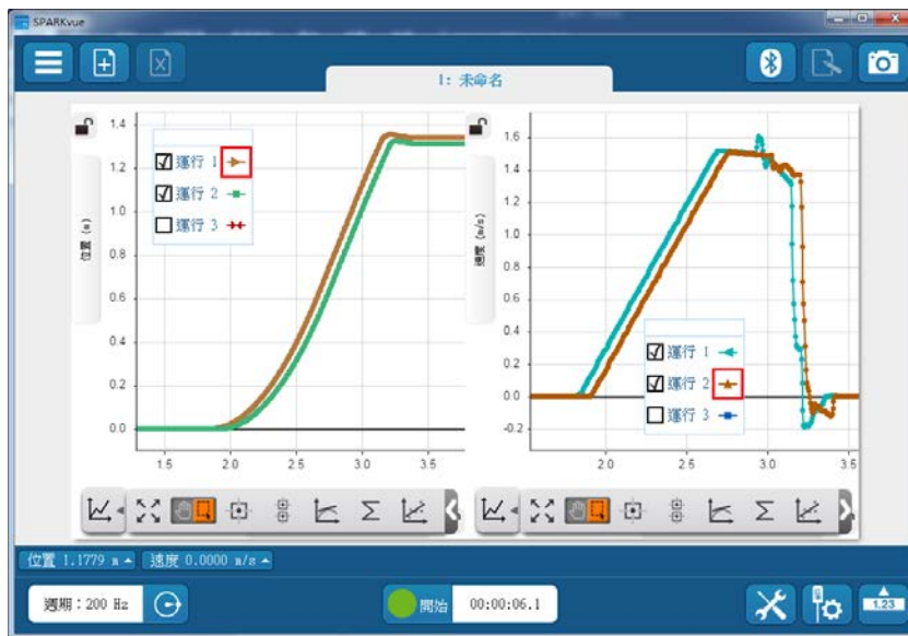
圖四、以數據擷取程式得到滑車加速過程的 x(t) 圖 以及 v(t) 圖。
