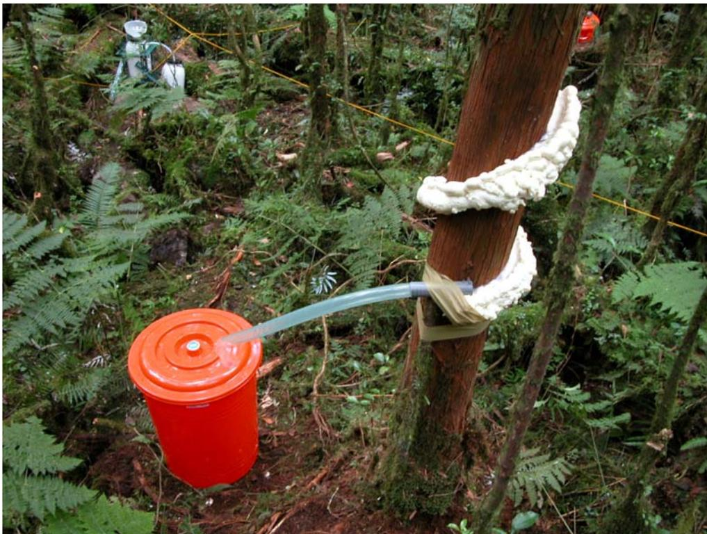
圖 9 螺旋式幹流水收集器。
