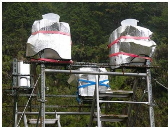
圖 6 雨水收集器與傾斗式雨量計。(a)架設於天頂角 45° 內無遮蔽物的空曠地，高度為 3.5m 的鐵塔上。(b)雨量桶外包覆鋁箔遮光板，以防止藻類滋生影響雨水的化學組成。
