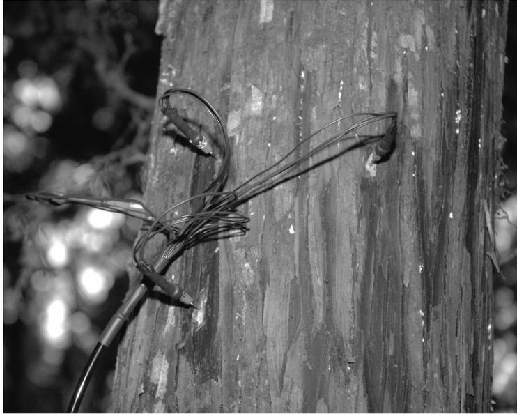
圖 9. 改良式樹液探針 (S-Type)。各探針相距 10cm，可避免被加熱端之熱源影響其他探針所測得之數值。
